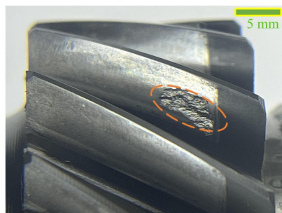
(d) 齿面严重点蚀
